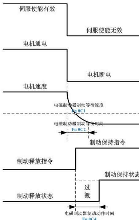
图 5-12 电磁制动器制动动作时序图（高速运行）
