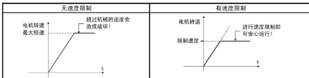
图 5-6 转矩模式下转速限制功能
